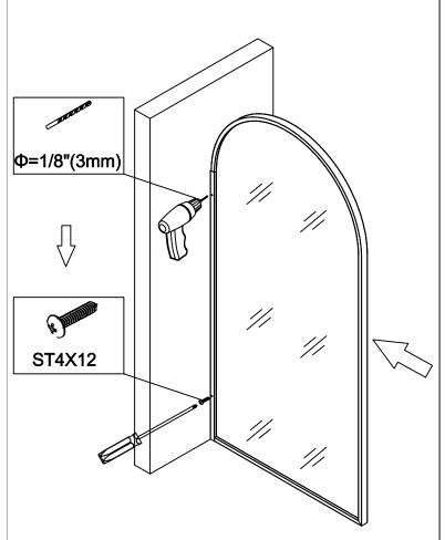
Insérez la paroi dans le profilé mural. Percez des trous, vissez à l'aide des vis ST4x12.
