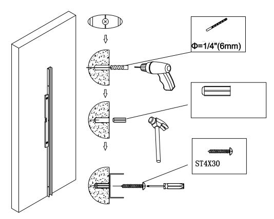
Placez le profilé mural à la verticale, et percez les trous en conséquence. Insérez l'ancrage mural, serrez la vis
