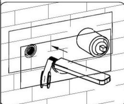
4. Enveloppez le connecteur du bec avec du ruban d'étanchéité. Puis installez la plaque.
