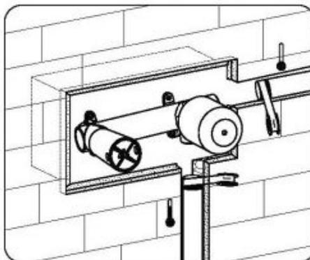
2. Raccordez les deux flexibles à l'arrivée d'eau chaude et d'eau froide, puis vérifiez s'il n'y a pas de fuites.
