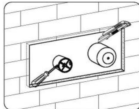
3. Recouvrez à l'aide de béton, puis lorsque le béton est sec, coupez avec un couteau le long des bordures.
