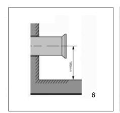
Alignez et approchez le WC entièrement assemblé contre le mur en enfonçant la sortie de la cuvette dans la pipe d'évacuation.
