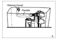
Remettez le robinet d'arrêt en place puis connectez la vanne d'arrivée d'eau au robinet d'arrêt.
