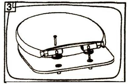
3 Enfoncer le boulon dans le joint d'expansion
