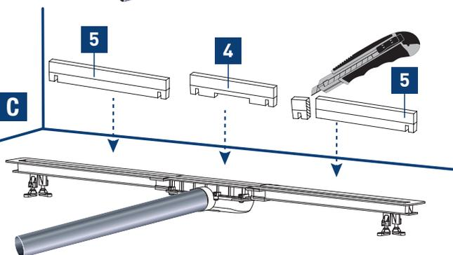
Placer la cale centrale d'obturation en polystyrène.
